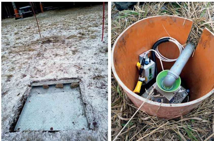
Obr. 2 Měření odtoku ze sněhu. A) Sněhový lysimetr pro sběr tající vody ze sněhu a B) Člunkový průtokoměr s dataloggerem.
